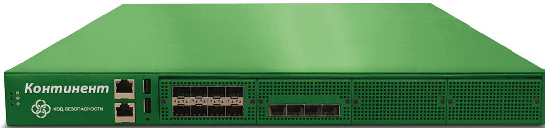
Централизованный комплекс для защиты сетевой инфраструктуры и создания VPN-сетей с использованием алгоритмов ГОСТ. Комплекс предназначен для решения таких задач, как защита периметра сети, объединение филиалов организации в виртуальную частную сеть (VPN), обеспечение защищенного удаленного доступа и обнаружение вторжений.
